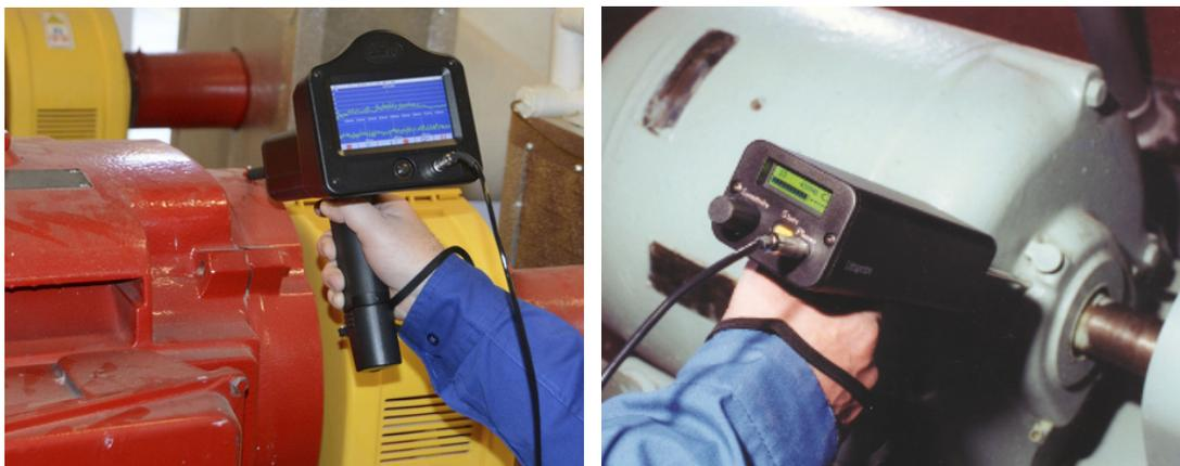
*Cuando sus rodamientos no están lubricados apropiadamente, la fricción puede causar daños y amenazar sus procesos. Sin embargo, los equipos de ultrasonido pueden leer los niveles de decibeles (dB) de los rodamientos que están sobre-lubricados o con carencia de lubricación e indicar a los técnicos de mantenimiento si los ajustes son correctos.*
