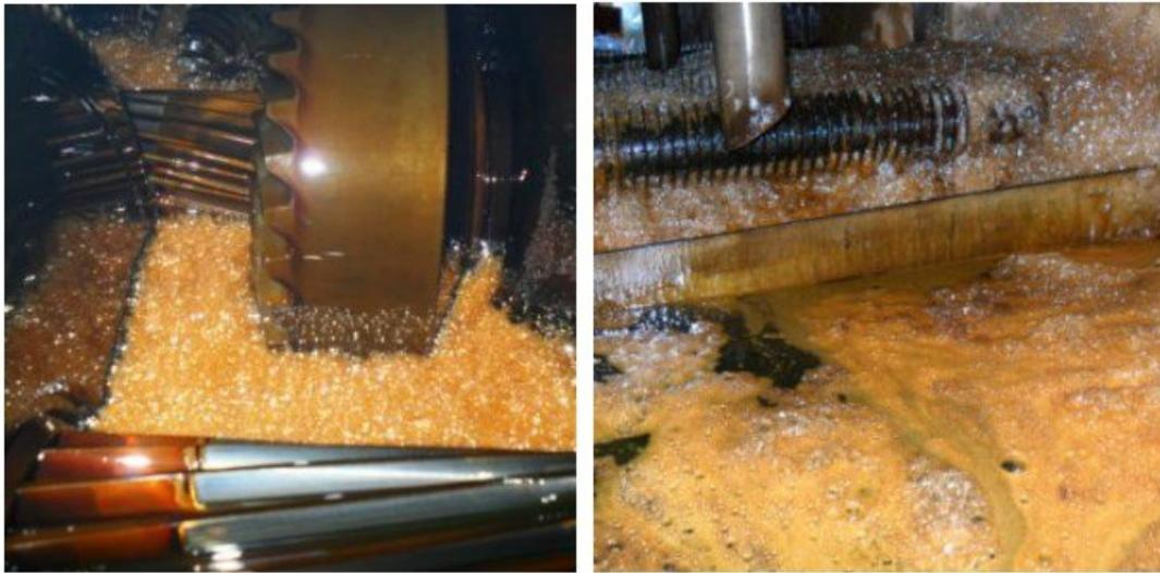
La espuma se abre paso en el aceite hacia el espacio superior de los tanques después de que el aceite se ha aireado inicialmente. Es común que hayan pequeñas cantidades de aire en el aceite, especialmente si este es agitado, como en una caja de engranajes. Sin embargo, a medida que el aceite airea más, las burbujas de aire subirán a la superficie. Dependiendo de la tensión superficial, estas burbujas estallarán o permanecerán intactas en forma de espuma.
