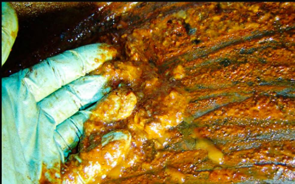
Los lubricantes pueden degradarse térmicamente por diferentes causas y razones. A diferencia de la oxidación, la falla térmica puede ocurrir en lubricantes nuevos con paquetes de aditivos sanos. Sin embargo, muchos de los síntomas de oxidación también son síntomas de degradación térmica.
