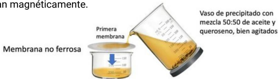
Fig. 2 Preparación de la membrana no ferrosa
