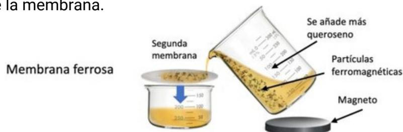
Fig. 3 Preparación de la membrana ferrosa
