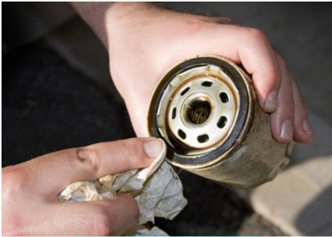
Inspeccione su filtro de aceite.
